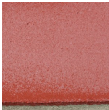
Abb. 2 Oberputz ohne ERASEAL120 nach dem Test: starkes Ausblühen und keine hydrophoben Eigenschaften
