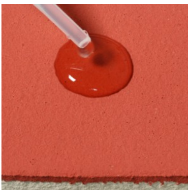
Abb. 1 Oberputz mit ERASEAL120 nach dem Test: ohne Ausblühen und gute hydrophobe Eigenschaften
