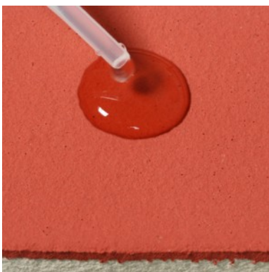
Fig.1 Enduit d'apprêt avec ERASEAL120 après test, sans efflorescence et avec bonnes propriétés hydrophobes
